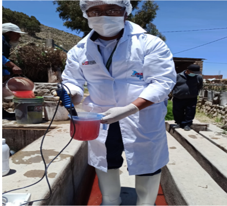
Medición de pH y oxígeno disuelto en muestra del efluente
